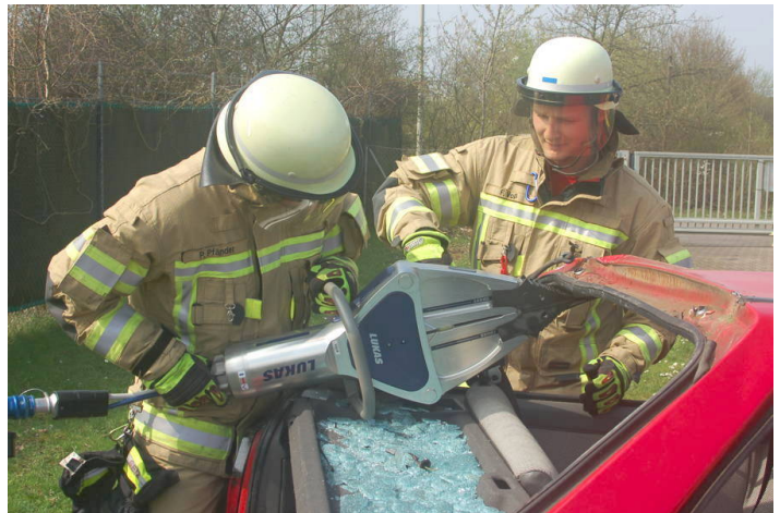
Beim Lehrgang lernen die Feuerwehrkameraden den Umgang mit dem hydraulischen Spreitzer.
