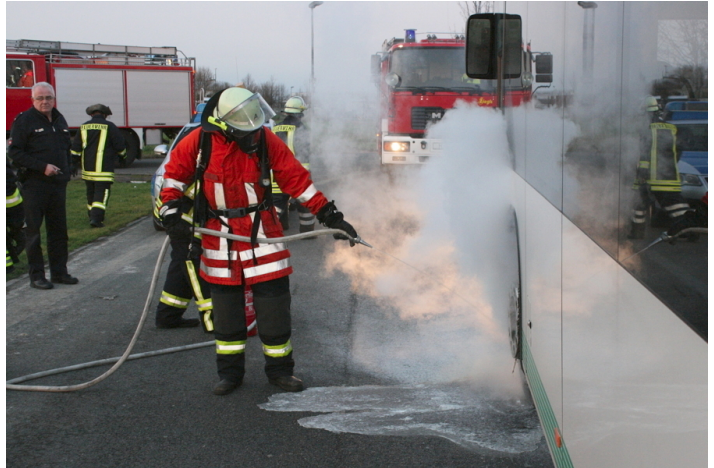
Die starke Dampfentwicklung zeugt von der großen Hitze des Rades und der Bremse.
