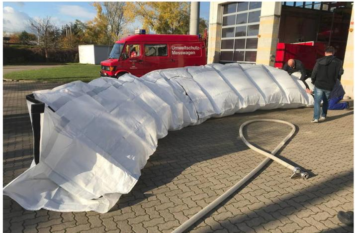
**Zwei Module zu je fünf Metern Länge mittels Klettverschluss verbunden und mit Luft befüllt. Auch Kurven lassen sich mit dem System verlegen.**
