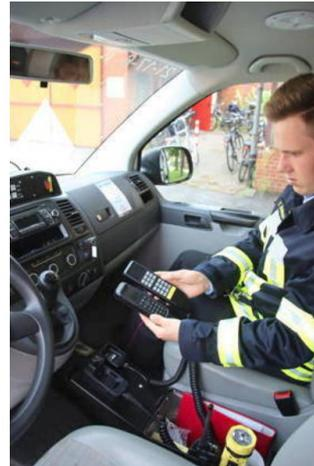
**Oberfeuermann Torben Brennecke (Ortsfeuerwehr Koldingen) zeigt die beiden Bedienteile zu den Funkgeräten: links digital (neu), rechts analog (alt).**
